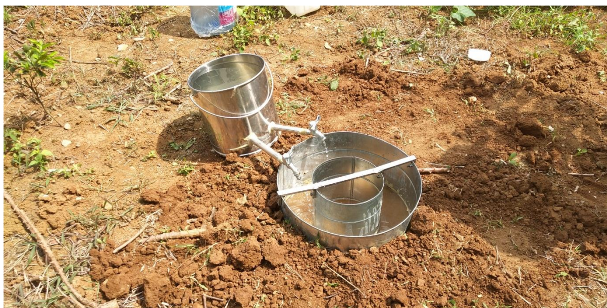
图 2-4-3 试坑试验 (SK1)
